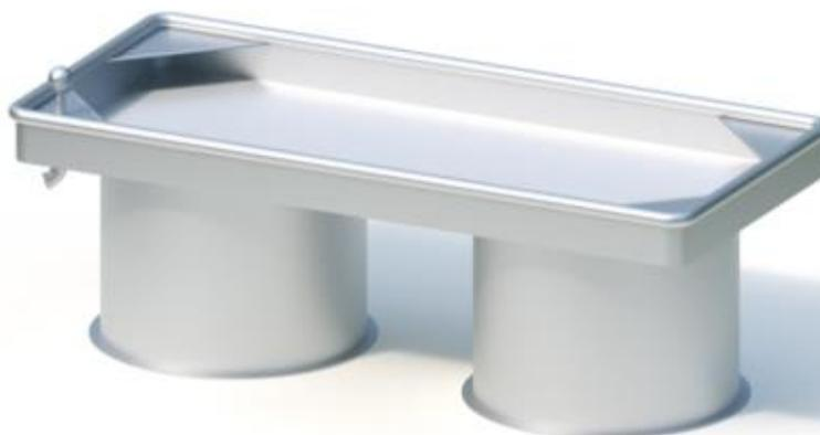
Verschweißte Edelstahlkonstruktion mit 1 Wasserablaufrohr. Gummikegelsverschluss mit Arretierung zur restlosen Wasserentnahme. 4 Ablagen. Blechdicke: min. 2 mm / Rohr Ø 38 mm. Verankerung am Flansching.
