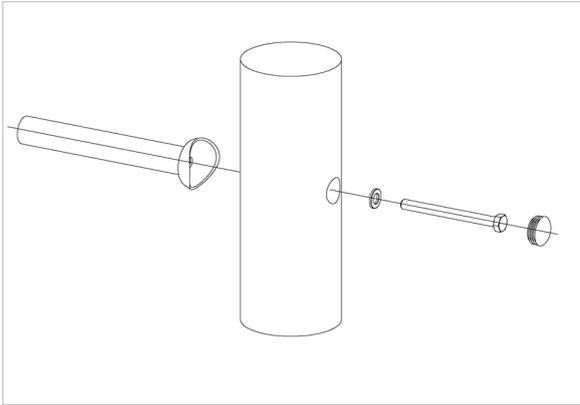
**16 x SFRS1230004 Standardverschraubung Kletterstange, Rampe usw. an Robinienstandpfosten (gesenkte Bohrung)**
