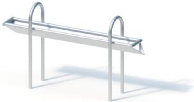
Verschweißte Edelstahlkonstruktion. Blechdicke: min. 2 mm / Rohr Ø 38 mm. Abgeschrägter Auslauf. Stufenlose Neigung zum Einbau für das erforderliche Gefälle für den Zu- und Ablauf des Wassers durch zusätzliche Aufständerung.
