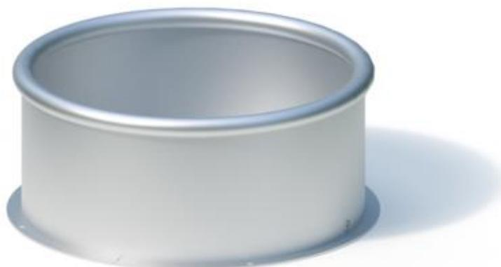
Verschweißte Edelstahlkonstruktion mit Aufnahmevorrichtung für das Fußlager der Wasserspirale, mit Ablaufbohrung. Wasserzulauf direkt unter oder z.B. mit einer Wasserrinne über dem Rohring.
