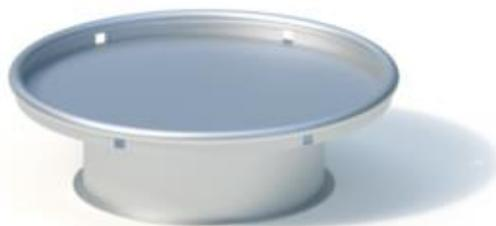
Verschweißte Edelstahlkonstruktion mit 6 Wasserablauföffnungen. Blechdicke: 2,5 mm / 2 mm / Rohr Ø 38 mm. Verankerung am Flanschring.
