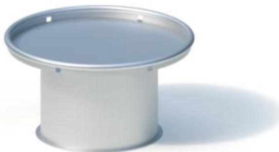
Verschweißte Edelstahlkonstruktion mit 6 Wasserablauföffnungen. Blechdicke: min. 2 mm / Rohr Ø 38 mm. Verankerung am Flanschring.
