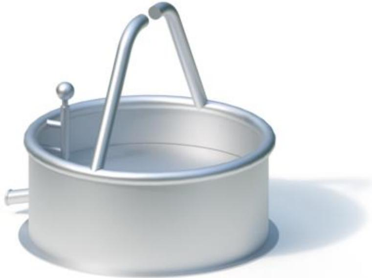
Verschweißte Edelstahlkonstruktion mit Aufnahmevorrichtung für das Kurbellager der Wasserspirale und ein Wasserablaufrohr. Blechdicke 2 mm / Rohr Ø 38 mm. Verankerung am Flanschring.
