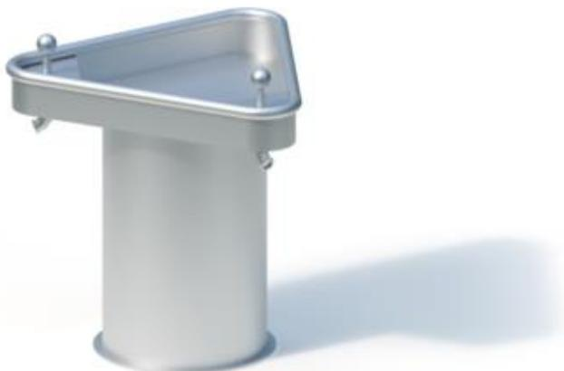
Verschweißte Edelstahlkonstruktion mit 2 Wasserablaufrohren. Gummikegelverschluss mit Arretierung zur restlosen Wasserentnahme. Blechdicke min. 2 mm/ Rohr Ø 38 mm.
