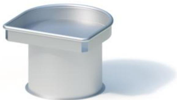
Verschweißte Edelstahlkonstruktion mit zwei Wasserablauföffnungen. Blechdicke: min. 2 mm/Rohr Ø 38 mm. Verankerung am Flansching.
