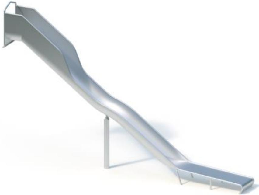
Einteilige Edelstahlkonstruktion, mit zusätzlicher Stütze im Auslaufbereich. Geschwindigkeitsregulierung durch Welle. Durch Muldenform besonders geräuscharm. Rutsche muss auf ein Streifenfundament oder einen anderen geeigneten Untergrund aufgedübelt werden.
