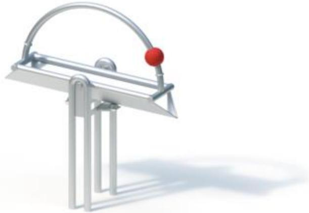
Verschweißte Edelstahlkonstruktion mit einstellbarer, stoßgedämpfter Kippmechanik zur Zweiwege-Wasserverteilung, mit Aufständerung und Wasserinne mit Kantenschutzrohr Ø 38 x 2 mm
