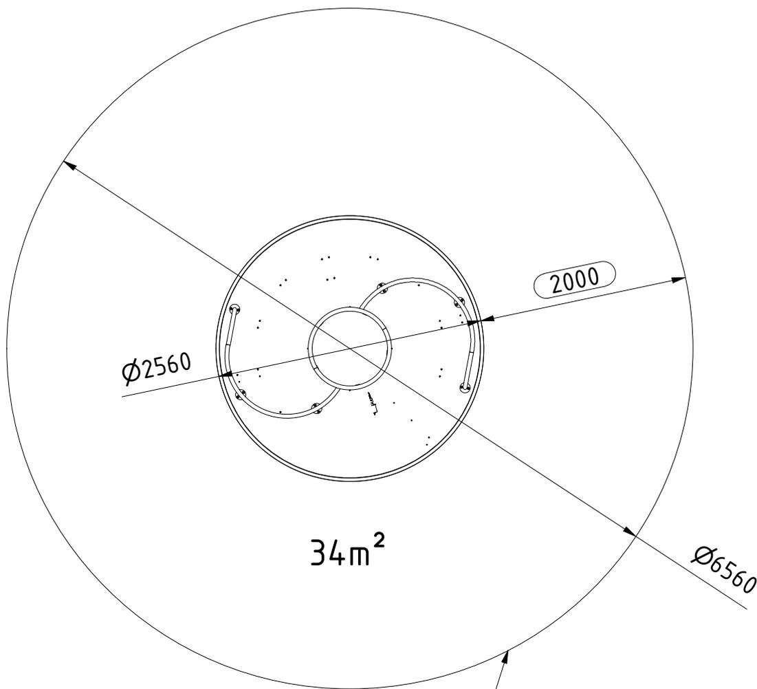
Aufprallfläche muss mit stoßdämpfendem Bodenmaterial (s. EN 1176-5) abgedeckt werden!
