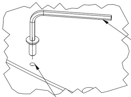
Eine Schraube wird mit dem Winkelschraubendreher in das M6 er Gewinde gedreht um den Wartungsdeckel damit leichter anheben zu können.
