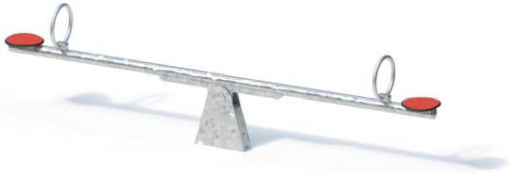
Wippbalken: Stahlrohr  $\varnothing$  82,5 x 6,3 x 3445 DIN 2458, feuerverzinkt
