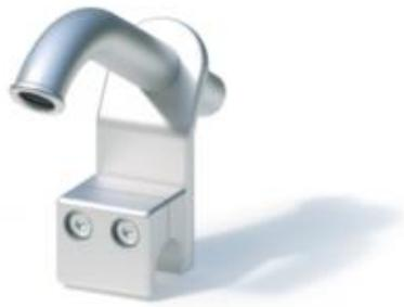
Verschweißte Edelstahlkonstruktion, Klemmteil zum Befestigen an Rohr Ø 33,7 mm, mit Anchlusselement geeignet für den Anschluss eines Gartenschlauches mit Schlauchstück 1/2" bzw. 3/4". (z.B. Gardena® oder vergleichbar).
