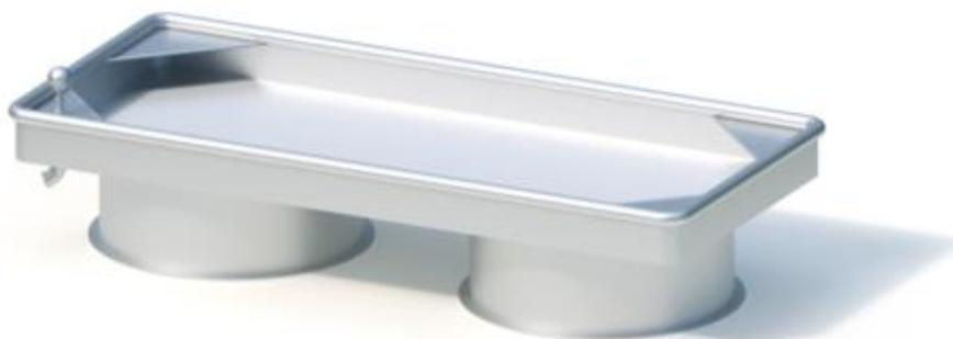
Verschweißte Edelstahlkonstruktion mit einem Wasserablaufrohr und vier Ablageflächen. Gummikegelverschluss mit Arretierung zur restlosen Wasserentnahme. Blechdicke: 2 mm / Rohr Ø 38 mm.
