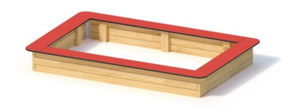
Sandeinfassung aus Robinie  $45 \times 100$  mm, gehobelt, gefast und frei von Faulästen. Spiel- und Sitzplatte aus höchst witterungsbeständiger farbigen HPL-Schichtstoffplatte, 20 mm.
