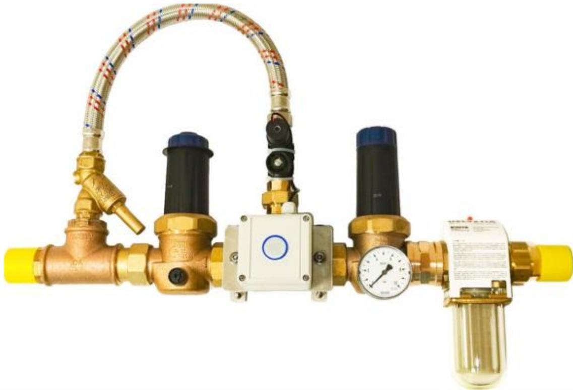
Vorrichtung zum direkten Anschluss der Wasserpumpe an eine Druckwasserleitung mit Feinfilter zur Reinigung des Wassers von Schwebstoffen, Schmutzpartikeln etc., um ein Verschmutzen der Membranventile zu verhindern und damit Funktionsstörungen vorzubeugen.
