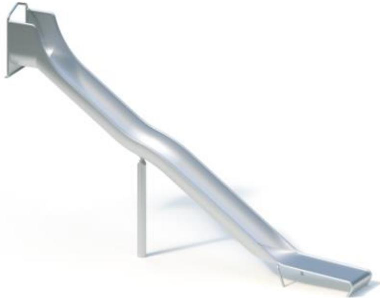
Einteilige Edelstahlkonstruktion, mit zusätzlicher Stütze im Auslaufbereich. Geschwindigkeitsregulierung durch Welle. Durch Muldenform besonders geräuscharm. Rutsche muss auf ein Streifenfundament oder einen anderen geeigneten Untergrund aufgedübelt werden.
