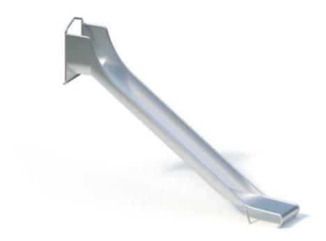
Einteilige Edelstahlkonstruktion, mit zusätzlicher Stütze im Auslaufbereich. Durch Muldenform besonders geräuscharm. Rutsche muss auf ein Streifenfundament oder einen anderen geeeigneten Untergrund aufgedübelt werden. Bitte beachten Sie, dass im Bereich des Flansches am Rutscheneinsitz ein zum Befestigen geeigneter Untergrund (Holzpodest oder -bohlen, Betonfundament o.ä.) bauseits vorhanden sein muss.
