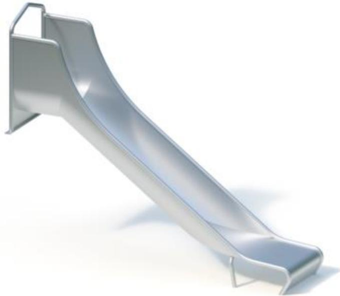
Einteilige Edelstahlkonstruktion, mit zusätzlicher Stütze im Auslaufbereich. Durch Muldenform besonders geräuscharm. Rutsche muss auf ein Streifenfundament oder einen anderen geeigneten Untergrund aufgedübelt werden. Bitte beachten Sie, dass im Bereich des Flansches am Rutscheneinsatz ein zum Befestigen geeigneter Untergrund (Holzpodest oder -bohlen, Betonfundament o.ä.) bauseits vorhanden sein muss.
