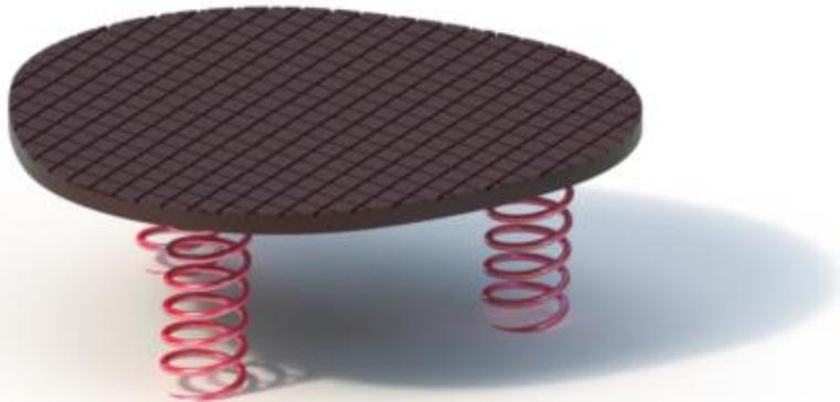
Platte aus hochverdichtetem Kunstharzpressholz (PAGHOLZ), hoch verschleißfest, witterungs- und temperaturbeständig, UV stabil, rutschfeste Oberfläche durch Fräsnuten, 20 mm dick.
