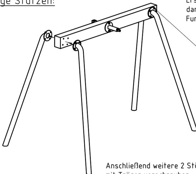
Erst 2 Stützen mit Träger verschrauben, dann aufrichten und mit Bewehrung in Fundamentlöcher stellen.
