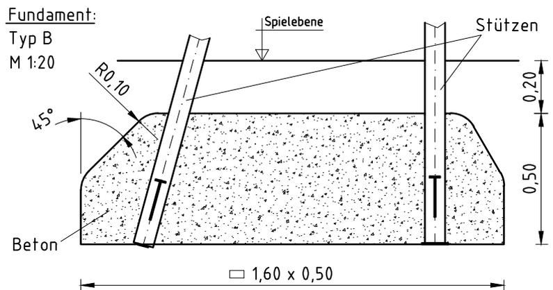
\*) Maß bei synthetischem Belag, der mit der umgebenden Fläche bündig abschließt und stoßdämpfende Wirkung hat. (s.EN 1176-2)
