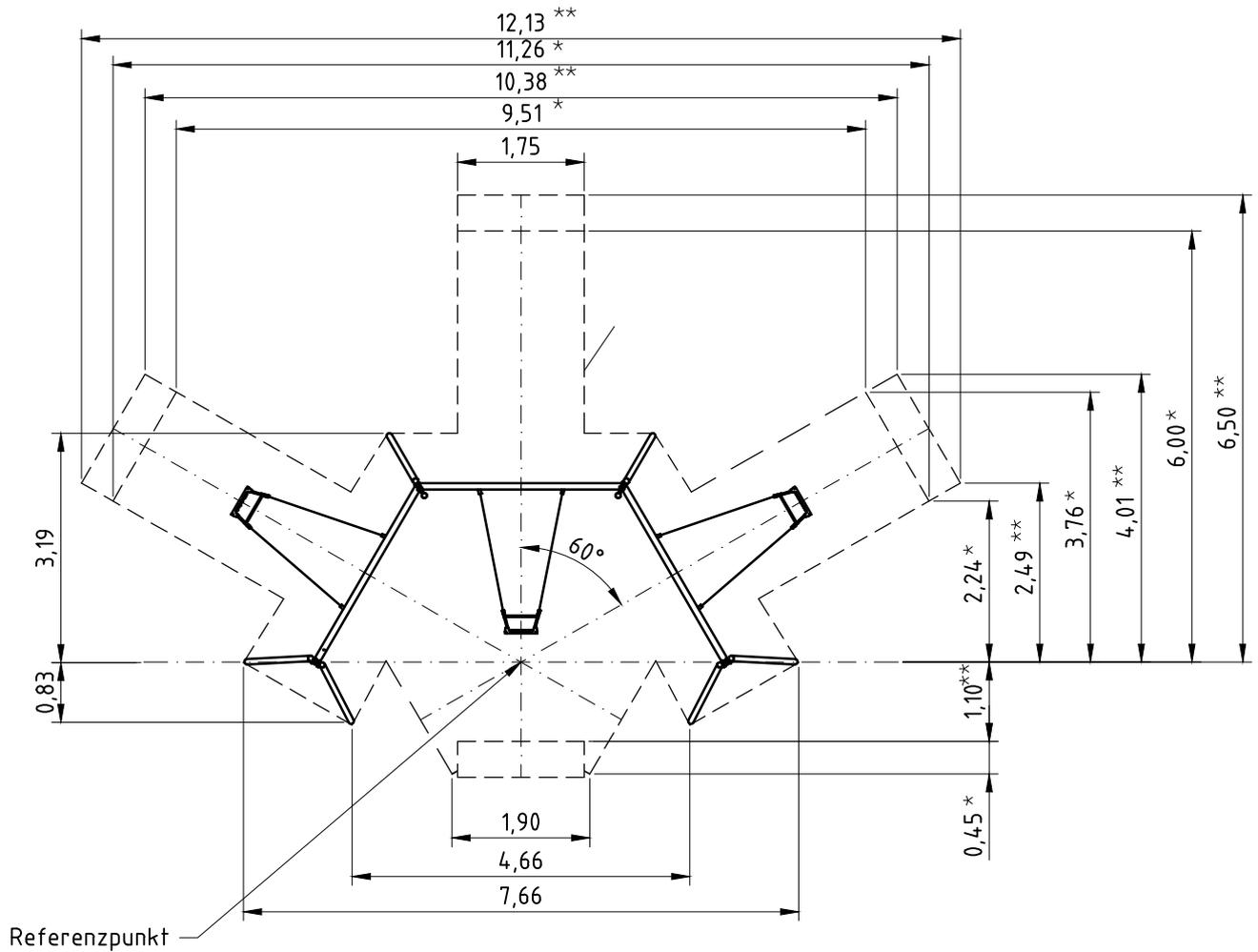
\*) Maß bei synthetischem Belag, der mit der umgebenden Fläche bündig abschließt und stoßdämpfende Wirkung hat. (s.EN 1176-2)
