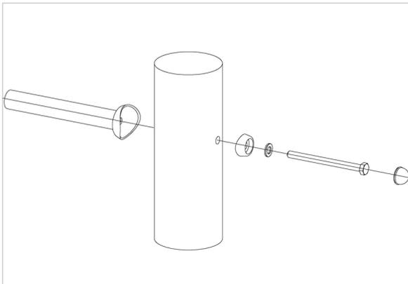
**4 x SFRS1210001 Standardverschraubung Anbauteile an Holzpfosten**
