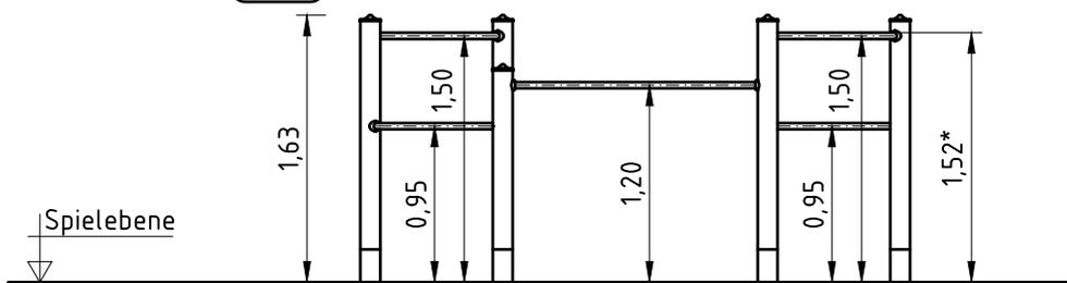
Kennzeichnung der Maßangabe für die maximale freie Fallhöhe
