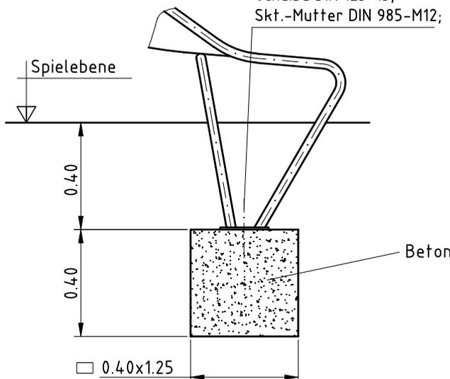
Abhängig vom Geländeverlauf ergibt sich die freie Fallhöhe aus dem lotrechten Abstand zwischen Unterkante Rutschwanne bis Oberkante Gelände; die stoßdämpfende Bodenart für die Aufprallfläche ist so zu wählen, dass deren kritische Fallhöhe größer oder gleich der freien Fallhöhe ist (vgl. EN 1176-1, Tabelle 4).
