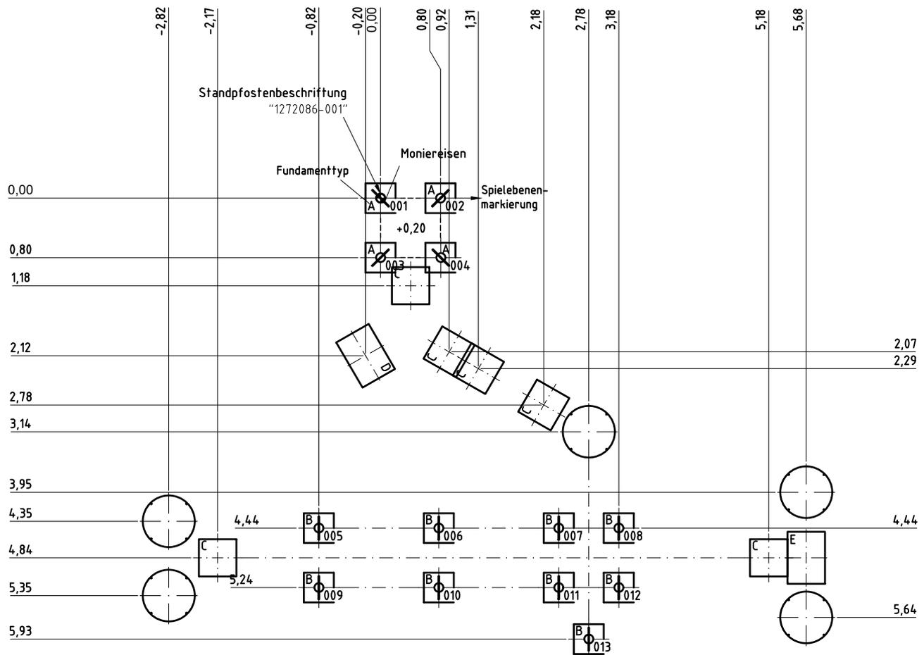
Entsprechend der Darstellung im Fundamentplan überlagern sich einige Fundamente geringfügig oder nähern sich so dicht an, dass sie miteinander verbunden werden können.
