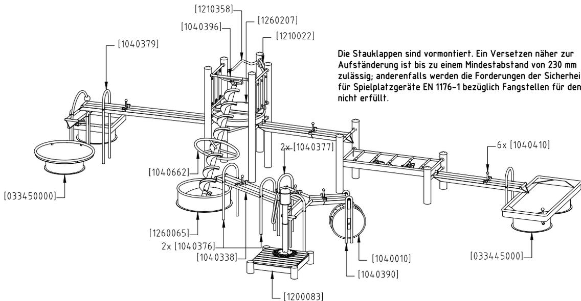
Die Stauklappen sind vormontiert. Ein Versetzen näher zur Aufständering ist bis zu einem Mindestabstand von 230 mm zulässig; anderenfalls werden die Forderungen der Sicherheitsnorm für Spielplatzgeräte EN 1176-1 bezüglich Fangstellen für den Kopf nicht erfüllt.
