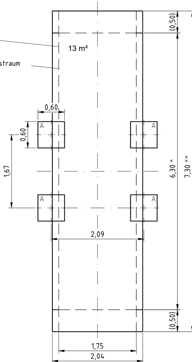
\*) Maß bei synthetischem Belag, der mit der umgebenden Fläche bündig abschließt und stoßdämpfende Wirkung hat. Zusätzlich muss eine bündig abschließende hindernisfreie Strecke in Schaukelrichtung von 0,50 m Länge vorhanden sein (vgl. EN 1176-2).
