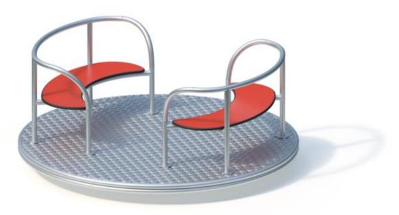
Mitdrehender Boden und Aufbau: profiliertes Edelstahlblech/Edelstahl/Hochdrucklaminat 20 mm Wälzlagerung: eingriffsicher und schmutzgeschützt. Karussellverankerung erfolgt über einen separat einzubetonierenden Flanschring.
