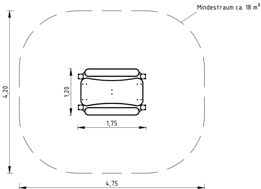
1. Standort für das werkseitig vormontierte Gerät unter Berücksichtigung des Platzbedarfs wählen (Mindestraum).
