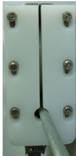
Für einen sauberen Lauf des Wagens, und um Verkanten oder Verletzung des Seils auszuschließen, können die seitlichen Anschlagplatten am Seilwagen mittels der Langlöcher in der Höhe verstellt werden.
