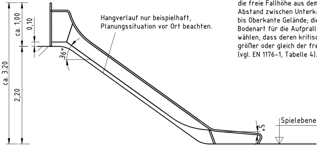
Abhängig vom Geländeverlauf ergibt sich die freie Fallhöhe aus dem lotrechten Abstand zwischen Unterkante Rutschwanne bis Oberkante Gelände; die stoßdämpfende Bodenart für die Aufprallfläche ist so zu wählen, dass deren kritische Fallhöhe größer oder gleich der freien Fallhöhe ist (vgl. EN 1176-1, Tabelle 4).
