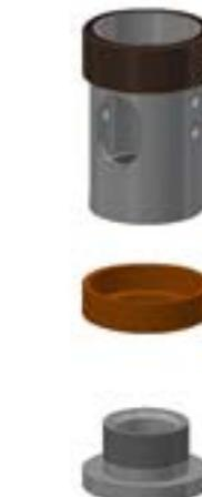
5. Nachdem die alte Ledermanschette entfernt wurde, sollten das Innen- und das Außengewinde der Kolbenteile gereinigt werden.
