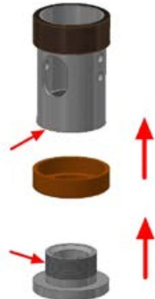
7. Beim Zusammensetzen des Pumpenkolbens mit dem Pleuel und der Achse müssen die Einbaurichtungen der Distanzhülsen im Pumpenkolben (Radius Richtung Kolbenmantel) und die Ausrichtung der Auslaufbohrung beachtet werden.
