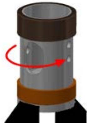
4. Ein geeignetes Rohr oder Rundmaterial als Hebel in die ovale Auslaufbohrung des oberen Kolbenteils einführen. Durch Drehen des Kolbenoberteils im Gegenuhrzeigersinn (rechtsgängiges Gewinde), werden das Kolbenoberteil und das Unterteil voneinander gelöst.
