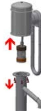
2. Zur einfacheren Handhabung wird der Pumpenkolben von der Pleuelstange demontiert. Dazu wird einer der Sicherungsringe, welche die Pumpenachse im Pumpenkolben fixieren, mit einer geeigneten Zange abgenommen. Dann lässt sich die Achse entfernen und der Kolben ist lose.
