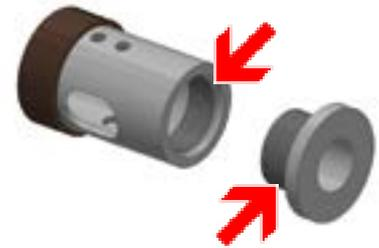
6. Vor dem Zusammensetzen der Kolbenteile mit der neuen Ledermanschette müssen die Gewinde mit einem Gewindesicherungs-Klebstoff (Loctite o.ä.) versehen werden, um ein ungewolltes Lösen während des Betriebes zu vermeiden.
