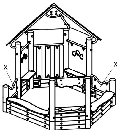
Die Anbauteile in den mit X gekennzeichneten Feldern müssen zuerst eingebaut werden.
